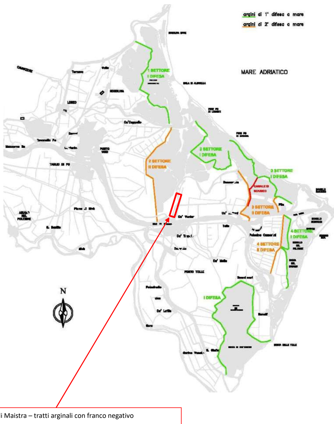
Figura 6. Sistema difensivo arginale dell'area deltizia per la difesa dal mare costituito da arginature di I e II linea di difesa dal mare
